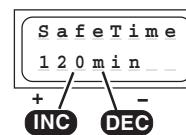
Lorsqu'un processus de charge est démarré, le Timer de sécurité incorporé démarre en même temps. Il doit empêcher qu'avec un accu défectueux ou un fonctionnement erroné de la détection pleine charge l'accu connecté soit totalement surchargé. Entrer ici une valeur de temps qui permette une pleine charge sûre de l'accu connecté. Selon le courant de charge réglé, à peu près 30% en plus du temps de charge attendu conviennent le mieux.
